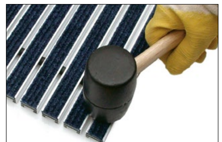
Incollare con nastro biadesivo le nuove strisce di reps nel profilo di alluminio ed eventualmente batterci sopra con un martello di gomma.
